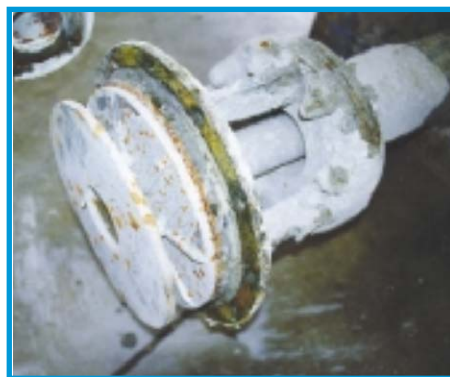
上图为使用了7年的盘片泵，处理含有固体颗粒的介质，如图显示盘片依然无任何磨损。
